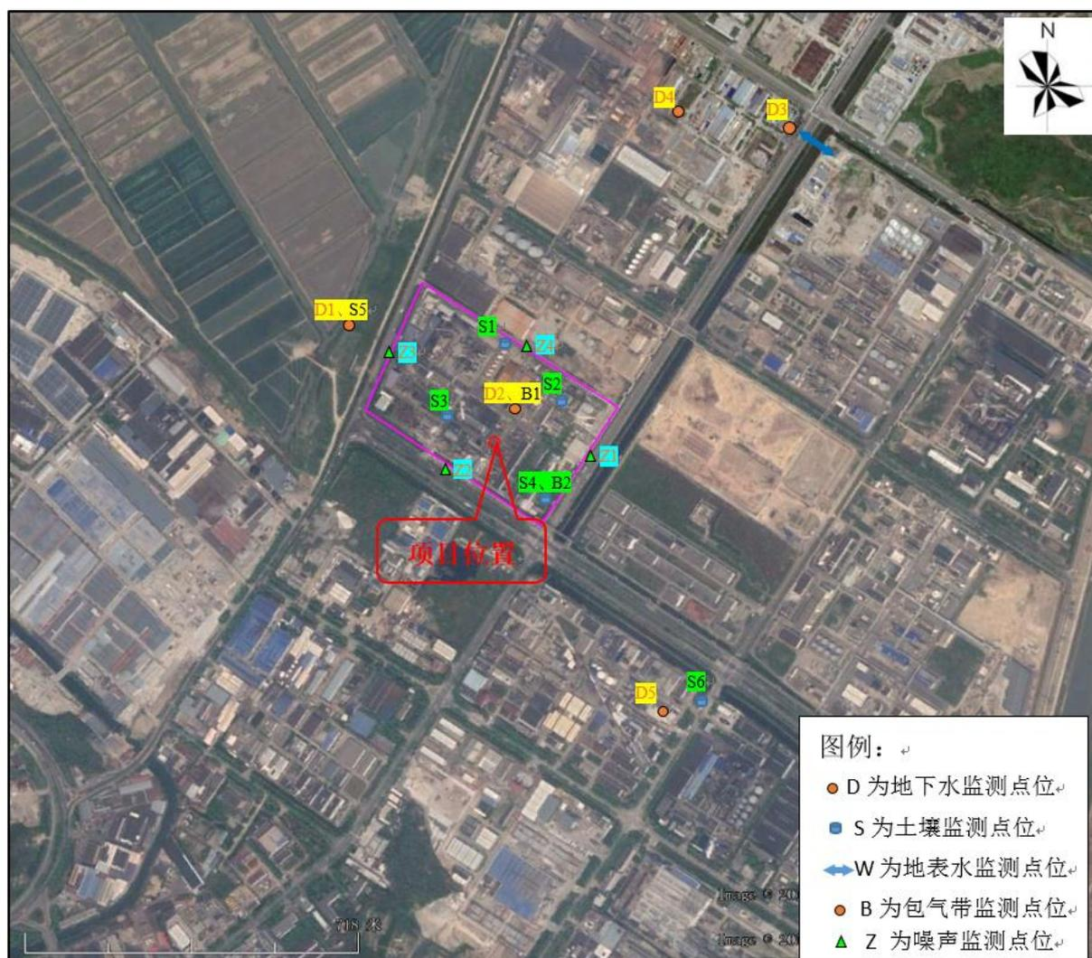
图 5.3-2 监测点位示意图（地表水、地下水、土壤、包气带）
